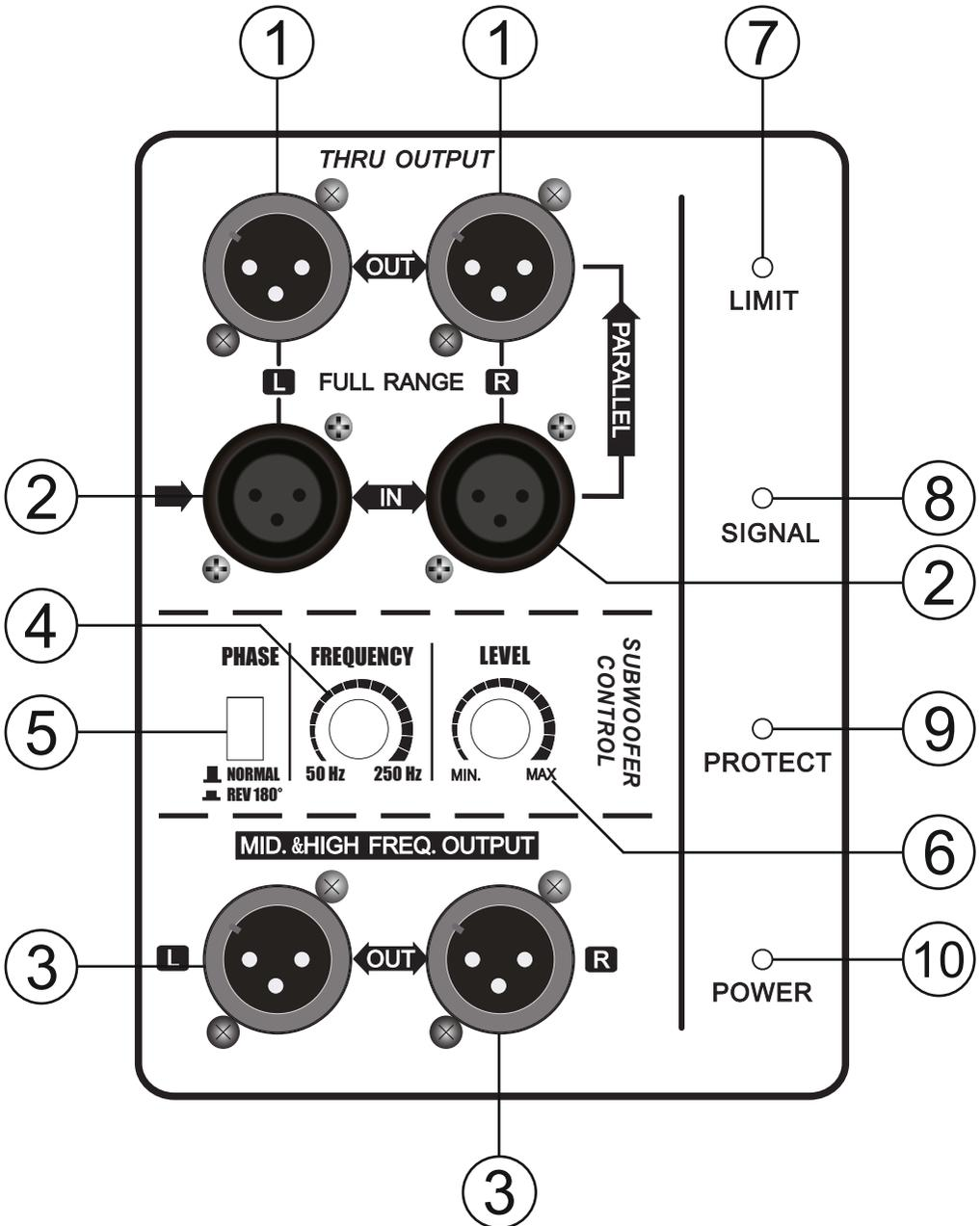
1. Сквозные линейные широкополосные выходы правого и левого каналов на разъемах XLR для подключения другой активной системы, усилителя или аналогичного субвуфера.
